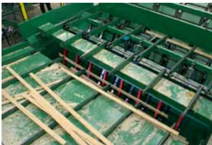
Durch den Puffer kann die Sägelinie im Falle einer Störung je nach Dimension noch 10 bis 30 min weiterlaufen und muss nicht angehalten werden
