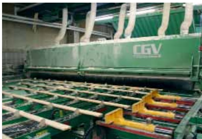
Die Kappsäge für den Querdurchlauf ist extrem robust aufgeführt und verlässlich im Betrieb
