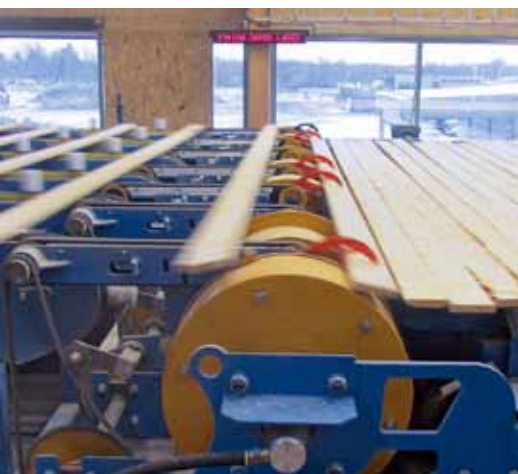
Vereinzelung in Braviken: elektrisch angesteuerte Pneumatic-Ventile erlauben 300 Bretter pro Minute
