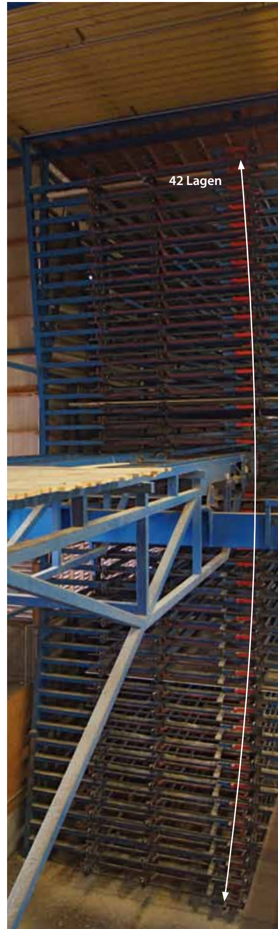
Mit 42 Lagen ist die CGV-Vorsortierung von Vida-Timber in Vislanda nach eigenen Angaben die weltgrößte Anlage dieses Typs
