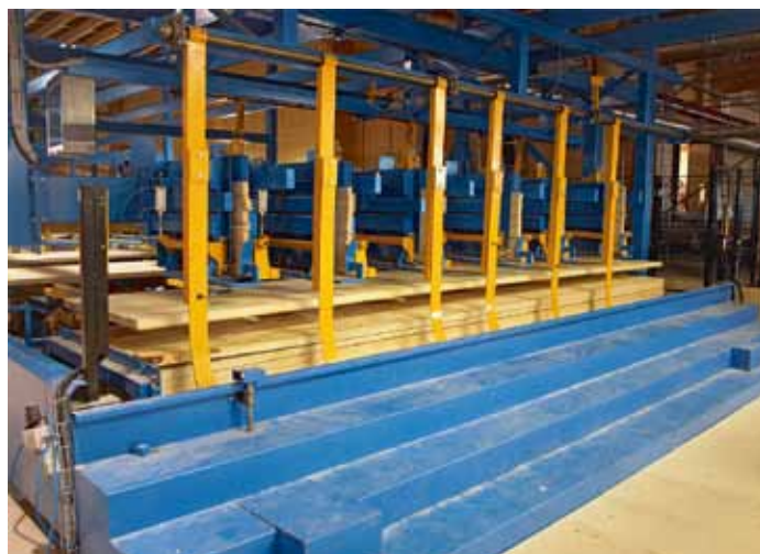
Der voll automatische Paketierer stapelt bis zu 6 m lange Pakete – dank einer Kappsäge können simultan zwei 3 m-Pakete geformt werden
