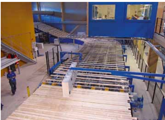
Bypass zum Hobelautomaten: Hier wird das Schnittholz nach links über die Waco-Hobelanlage mit 800 m/min befördert
